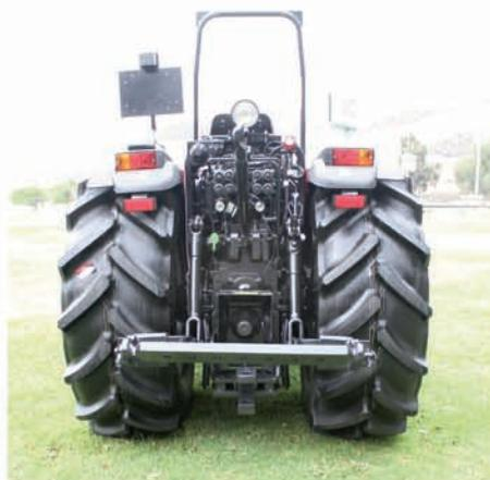
Barra de tiro deslizable con enganche de horquilla para una rápida y fácil conexión.
